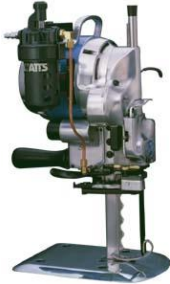
المقص الكهربائي المستطيل وسلاح السكينة متعرج ويعمل بالتزبييت الآلي شكل رقم (٣٣)
